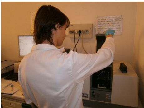
Realizando una electroscopía óptica de absorbancia a 280 nm
