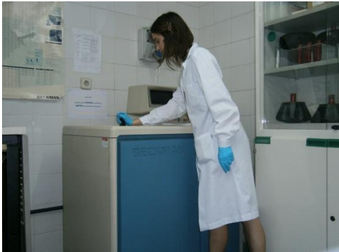
Ultracentrifugadora (de hasta 31000 rpm).
